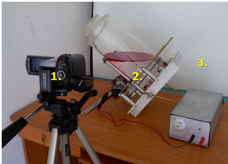
Figura 8. Fotografía modelo en acrílico transparente. Dimensiones a escala (1:7)
