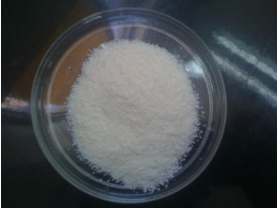
Figura 6. Quitosano comercial de caparaz3n de cangrejo, 85% deacetilado de alto peso molecular (Sigma Chemicals Co, St. Louis, Mo).
