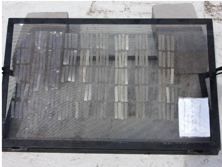
Figura 12. Muestras de polímero montadas sobre panel estacionario.
