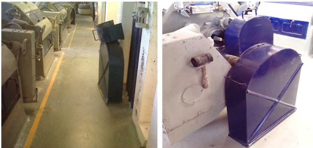
Figura 4.18. Colocación de protectores de seguridad.
