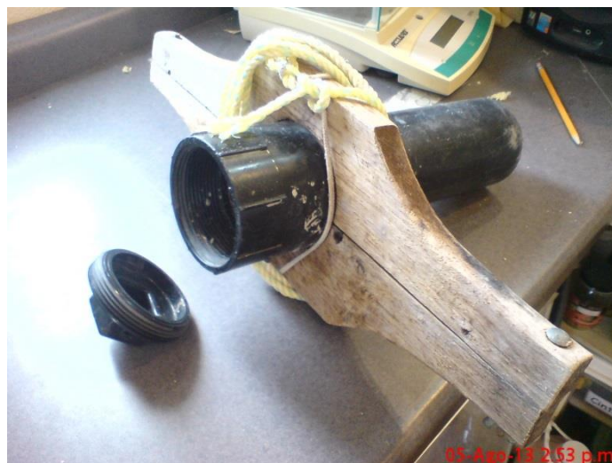
Figura 5.4. Imagen de nucleador utilizado en la colecta de muestras de sedimento.
