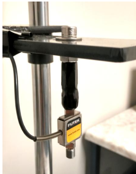
Figura 46. Celda de carga instalada en el carro móvil.
