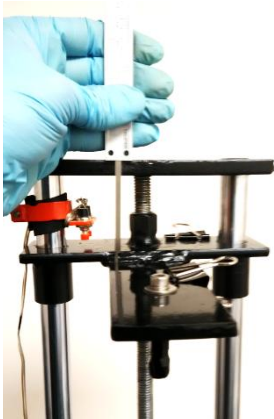
Figura 67. Esquema del procedimiento de medición del desplazamiento del carro móvil utilizando un calibrador vernier.
