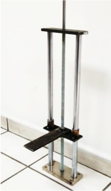
Figura 26. Conjunto de rieles, carro móvil, tornillo sin fin y placa superior.
