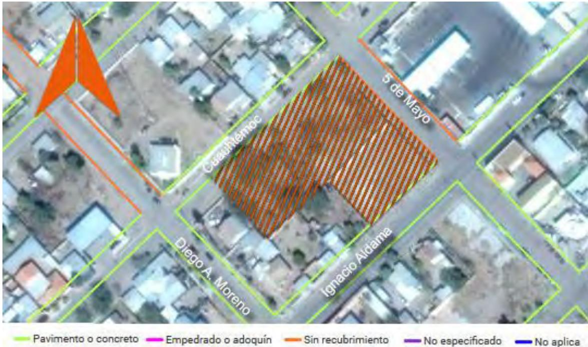
Imagen 31.- Estado del recubrimiento sobre las calles aledañas al terreno. Fuente: INEGI (manipulada) s/escala.
