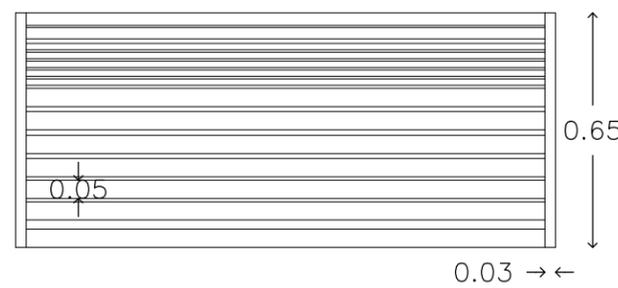
Estructura metálica hecha de pletina laminada 30 mm x 40 mm
