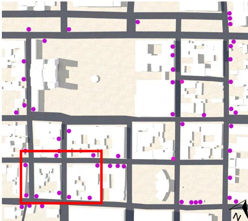
Los postes de telecomunicaciones se ven en el mapeo de la izquierda. Existen postes de concreto y de madera. Los postes de madera están en muy mal estado en el área marcada.
