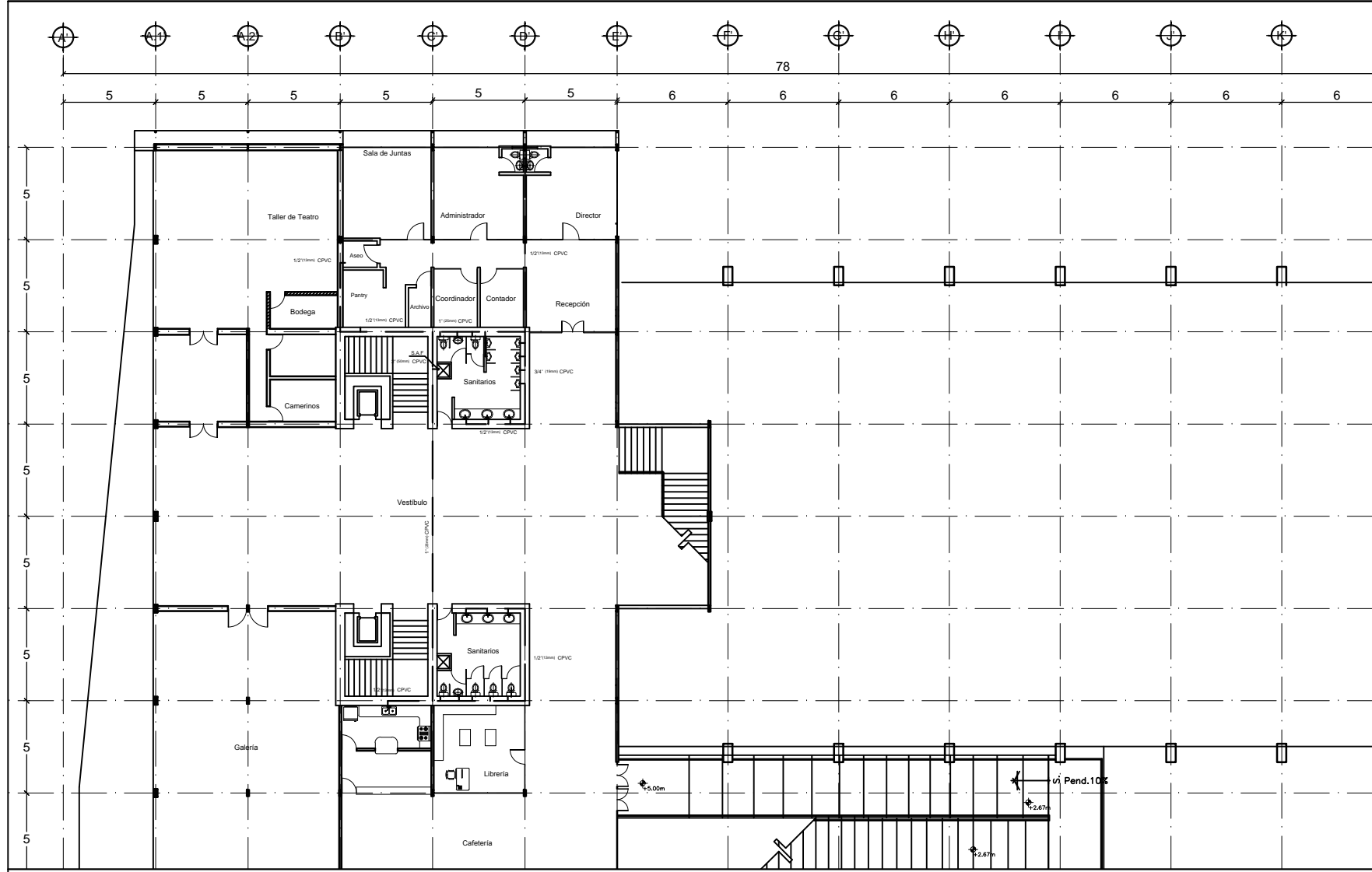
Planta primer nivel red hidráulica esc: 1:130
