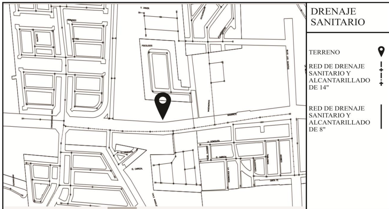
Imagen 17: Red municipal de Drenaje Sanitario. Agua de Hermosillo, 2012.
