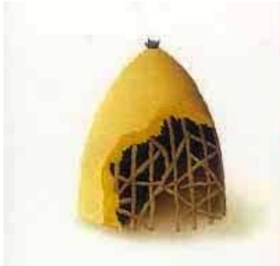
Imagen 4 Estructura de madera recubierta de adobe, fuente: http://cens30primercurso.blogspot.mx/2011
