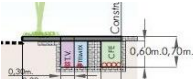
Ilustración 89: Instalaciones subterráneas. (Fuente: Manual de Espacio Público de Zapopan).
