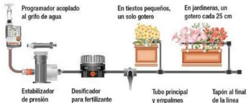
Ilustración 98: Funcionamiento de riego por goteo. (Fuente: www.verdeesvida.es ).
