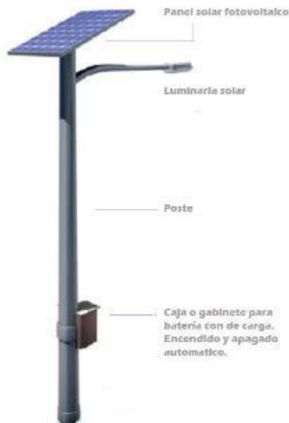
Ilustración 97: Ejemplo de luminaria solar. (Fuente: http://www.esco-tel.com ).
