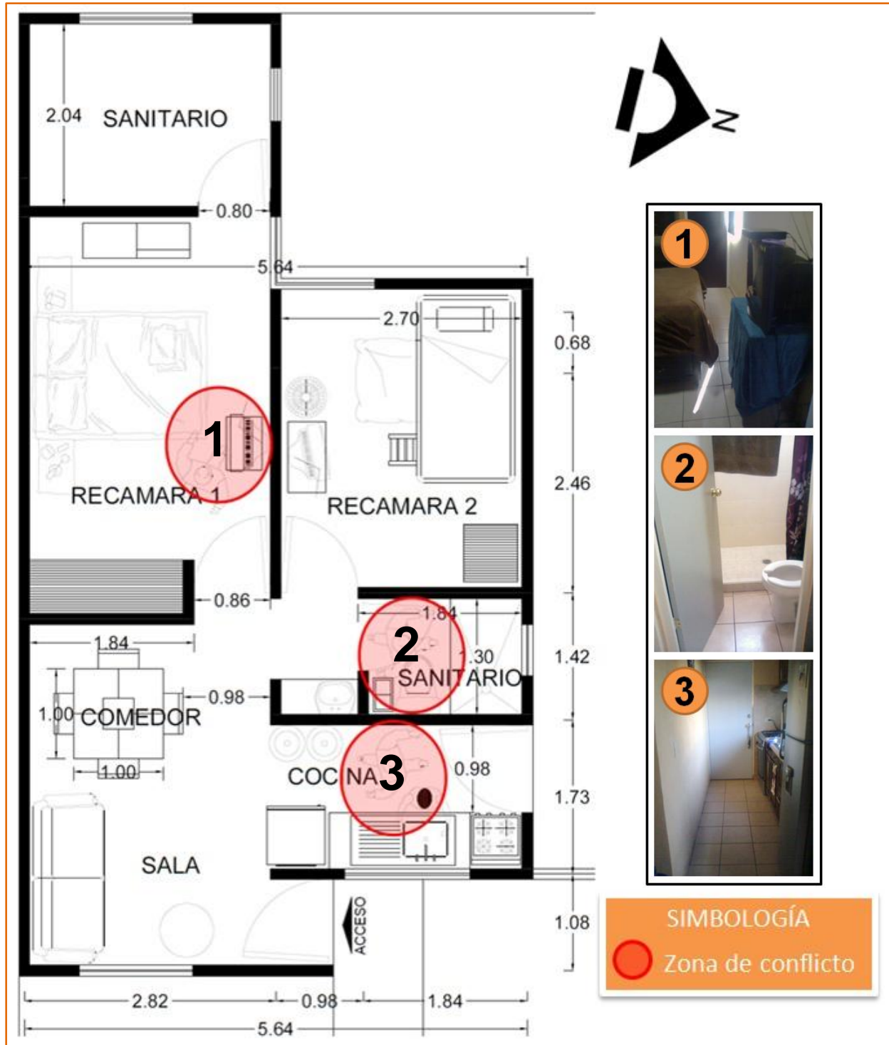
Imagen 4.5. Planta arquitectónica con zonas de conflicto del segundo caso de estudio. Fuente: Propia.
