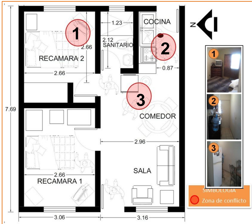
Imagen 4.3. Planta arquitectónica con zonas de conflicto del primer caso de estudio. Fuente: Propia.
