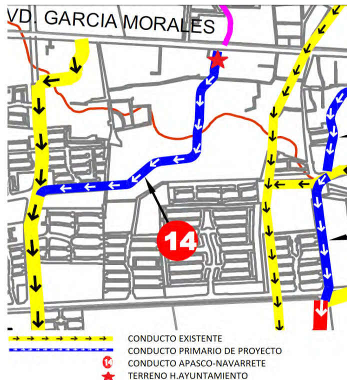
Ilustración 20: Programación de conductos pluviales. En amarillo vemos Quiroga (izq) y Quintero Arce (de), entre ellos el conducto primario futuro con el número 14 que atraviesa el terreno donde se emplazará el parque lineal Fuente: PLAN ESTRATÉGICO DE DRENAJE PLUVIAL DEL CENTRO DE POBLACIÓN DE HERMOSILLO 2010
