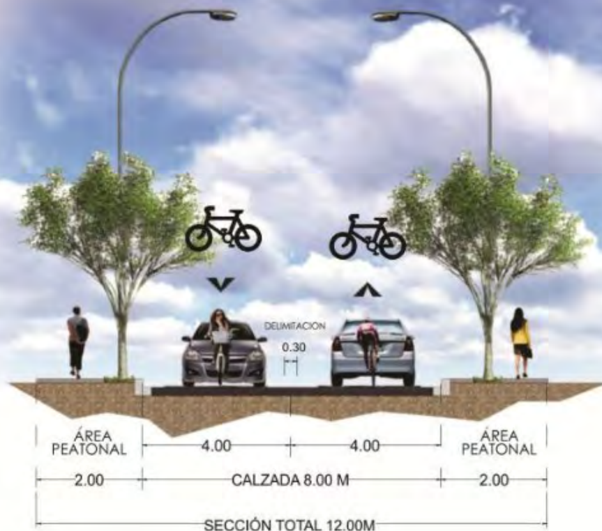
Ilustración 6: Sección de vialidad local
