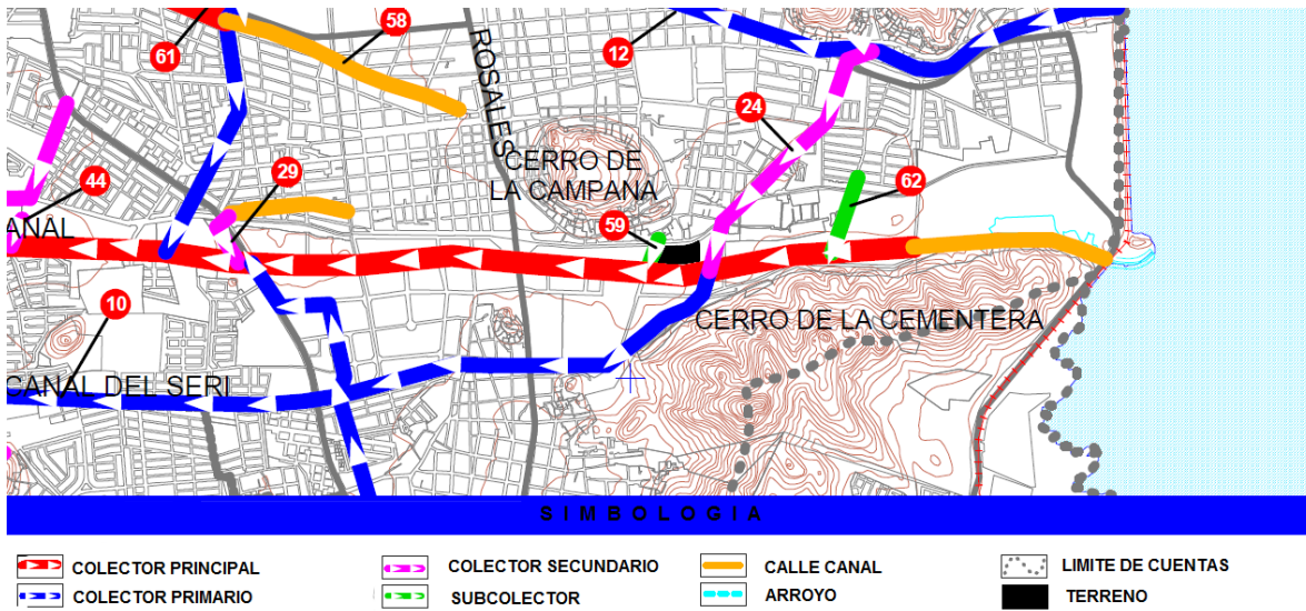
Ilustración 56 Colectores de drenaje cercanos al terreno. Fuente IMPLAN.
