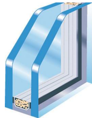
Ilustración 4 Ventanas de doble vidrio de espesor de 3/8" fuente: vilssa.com
