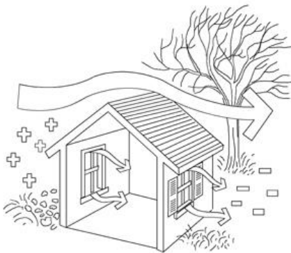
Ilustración 3 Diseño de utilización de vientos dominantes, fuente: ambientum.com
