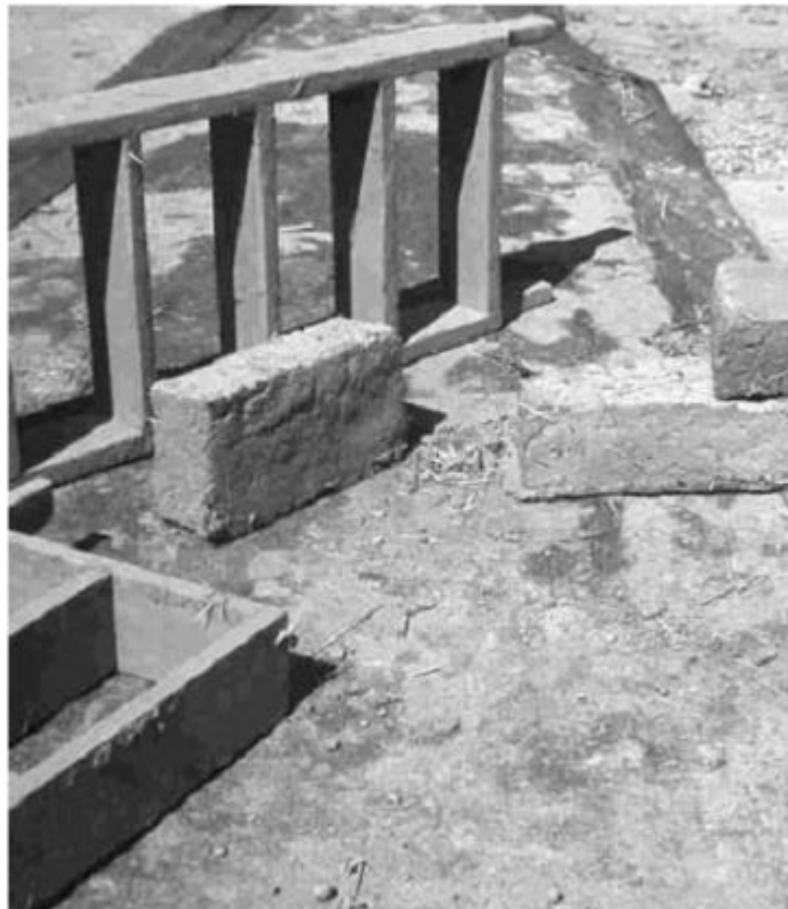
Fig.3.1.- El Adobe es un block elaborado con barro sin cocer.
