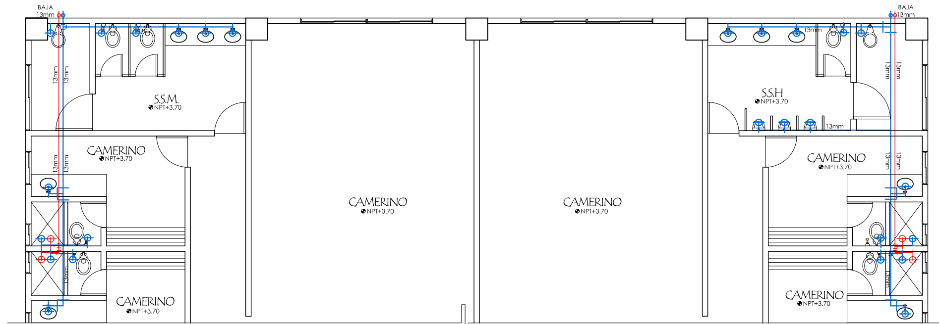
INSTALACIÓN HIDRÁULICA PLANTA ALTA ESC. 1:100
