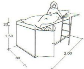
10 Armario-cama sobre un ropero bajo, para las habitaciones más reducidas, camarotes, estudios, etc.
