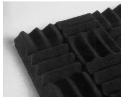
Fig. 2.1.24 Material absorbente a base de espuma de poliuretano.
