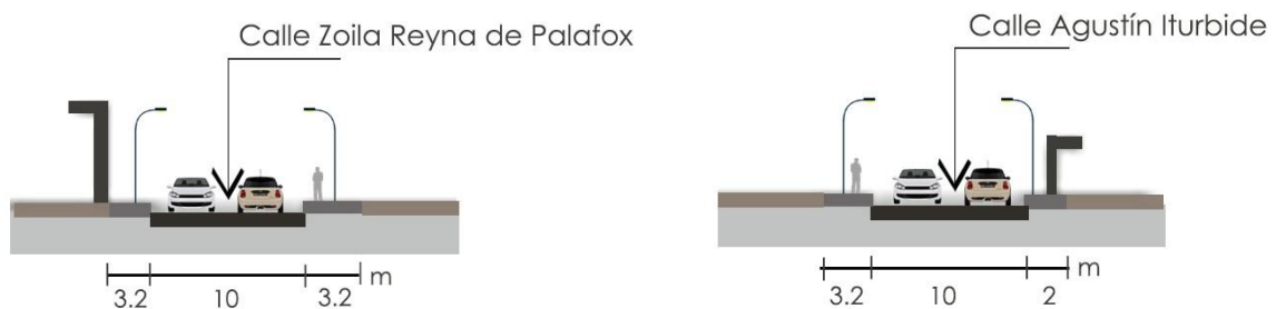
IMAGEN 16. Corte de vialidad Avenida Tamaulipas. Fuente: Propia, 2018.
