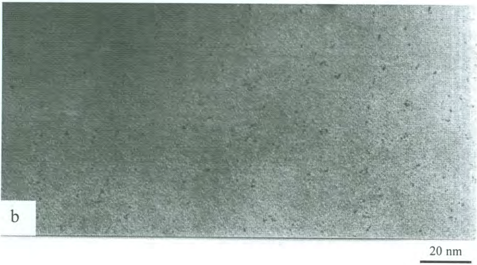
Figura 35. Micrografías de las nanopartículas de plata sintetizadas por el proceso 2: a) nanopartículas de plata, b) cúmulos de tamaño menor a 1 nm.
