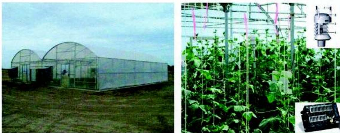
**Figura 6.** Invernadero del DAG, multisensor WXT510 y datalogger CR200.
