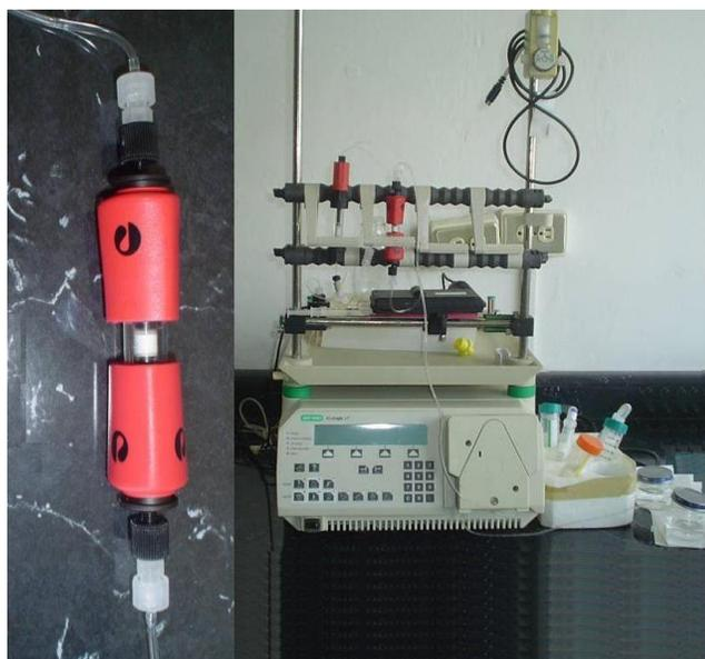
Figura 15. Columna empacada con membranas de intercambio iónico Mustang Q de Pall BioPharmaceuticals con un tamaño de poro nominal de 800 *nm*, las cuales, se cortaron a un diámetro de 5 *mm* y se acondicionaron según el protocolo del fabricante.
