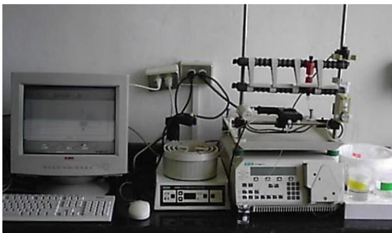
Figura 12. Columna empacada con membranas Mustang Q conectada al equipo BioRad BioLogic LP con monitor de computadora.
