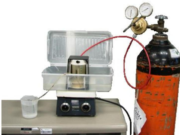
Figura 11. Celda de diafiltración amicon de Millipore con una membrana de la misma marca, fabricada con polietersulfona y de NMWL de 10,000. La celda se conectó a un tanque de nitrógeno puro a una presión menor de 55 *psi*.
