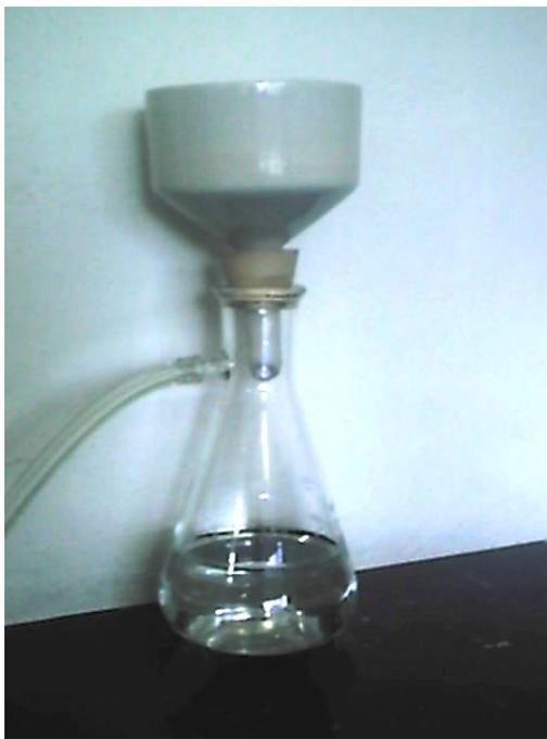
Figura 9. Sistema de vacío para eliminar los floculos generados en la lisis alcalina y neutralización de la etapa de recuperación de plásmidos.
