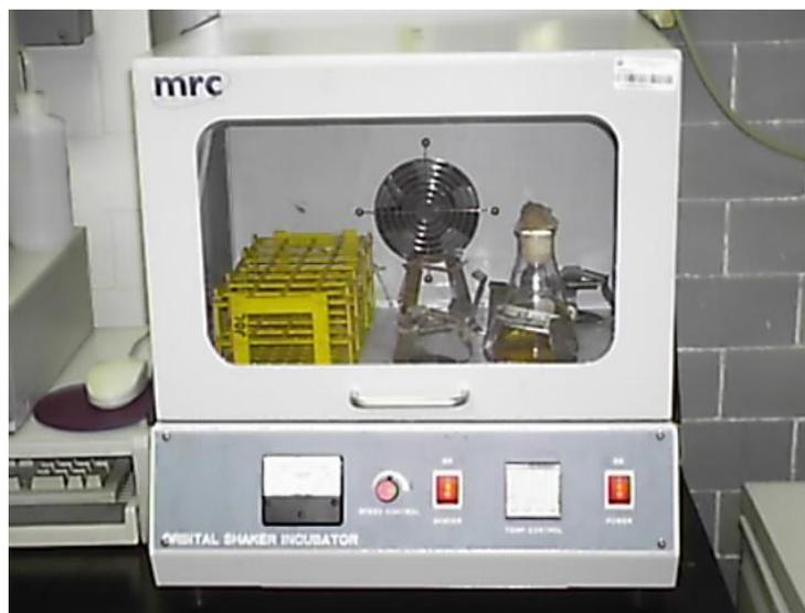
Figura 7. Crecimiento en matraz usando una incubadora (orbital shaker incubator) a condiciones de 225 rpm y 37 °C.
