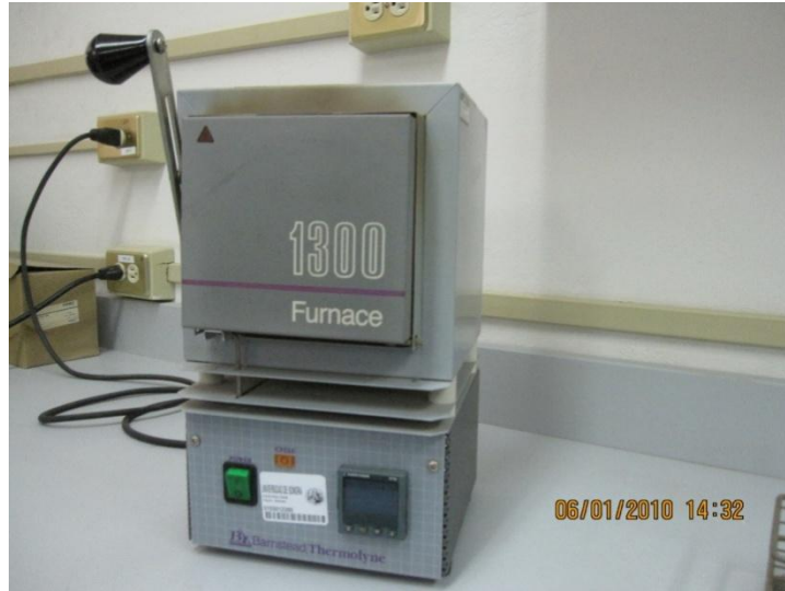
Figura 14.- Horno utilizado para el tratamiento térmico tanto de películas como de pastillas.
