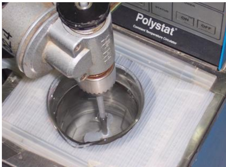
Figura 13.- Arreglo experimental para la síntesis de películas y polvo de ZnS.
