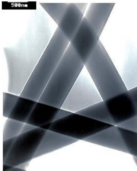
Figura 18. Microfotografía TEM de membranas AC/PVP/AC. Fuente [17]
