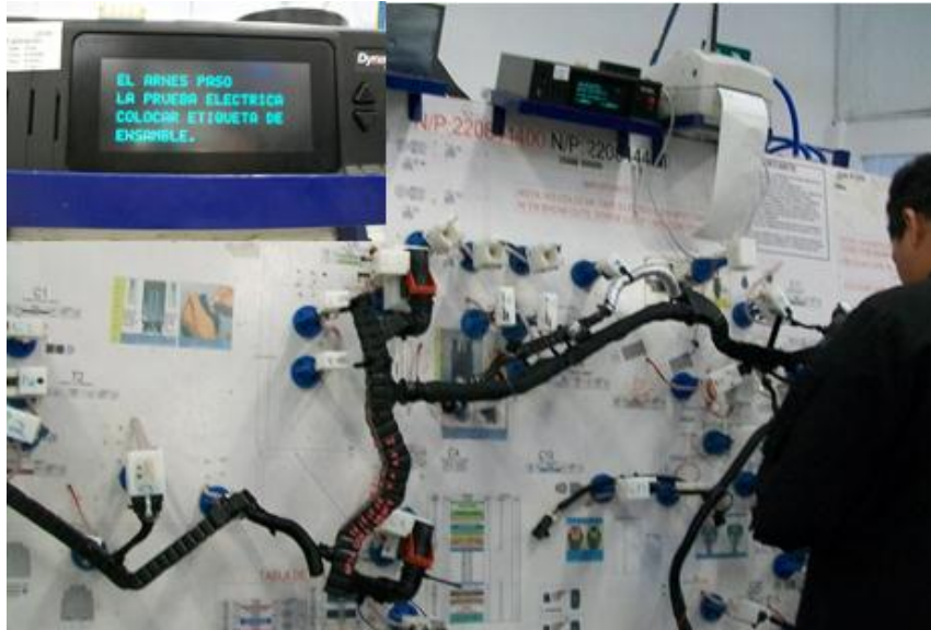
Figura 4.20 Arnés que pasó prueba eléctrica y dimensional (Archivo)
