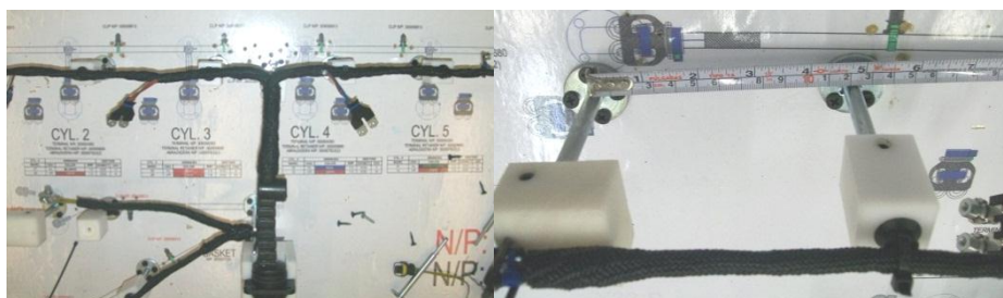
Figura 4.21 Arnés electrónico en tablero para colocación de cinta y accesorios (Archivo)
