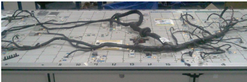
Figura 4.19 Arnés conectado en prueba eléctrica y dimensional (Archivo)
