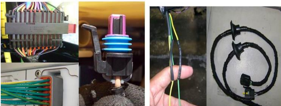
Continuación Figura 2.25 Componentes principales de un arnés electrónico (Archivo)
