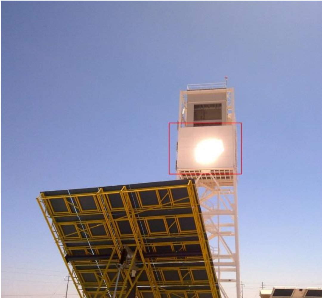
Figura 3.41 Blanco lambertiano posicionado en la torre central.
