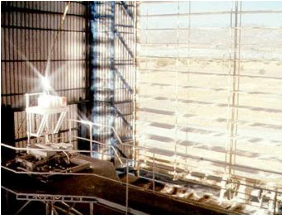
Figura 2.2 A la derecha en la imagen se observa una persiana que regula la cantidad de radiación que se envía al concentrador.
