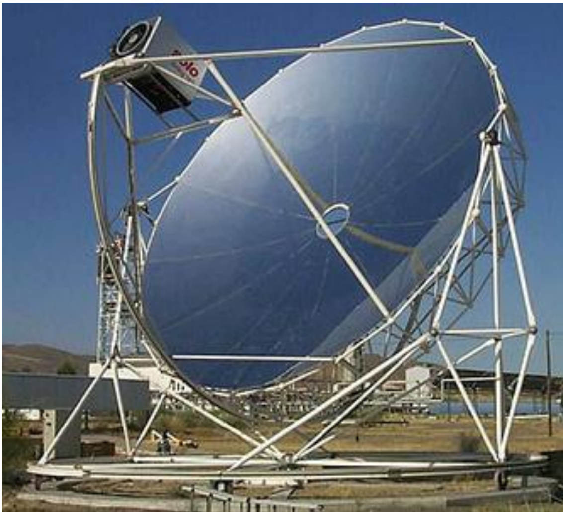
Figura 1.5 Concentrador solar, con motor Stirling montado en su foco.
