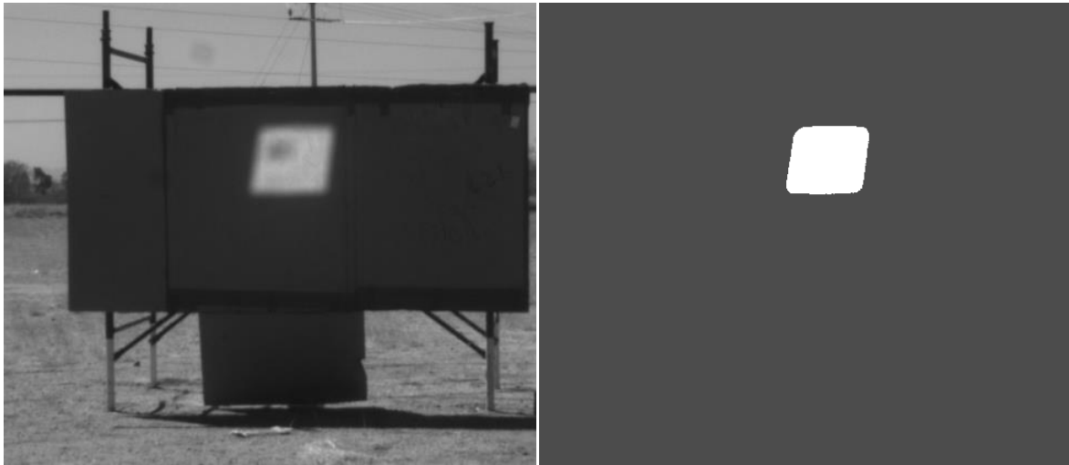
Figura 3.44 Imágenes de la proyección frontal del helióstato sobre una superficie (izquierda). Tratamiento de la misma imagen con función de umbral de color (derecha).
