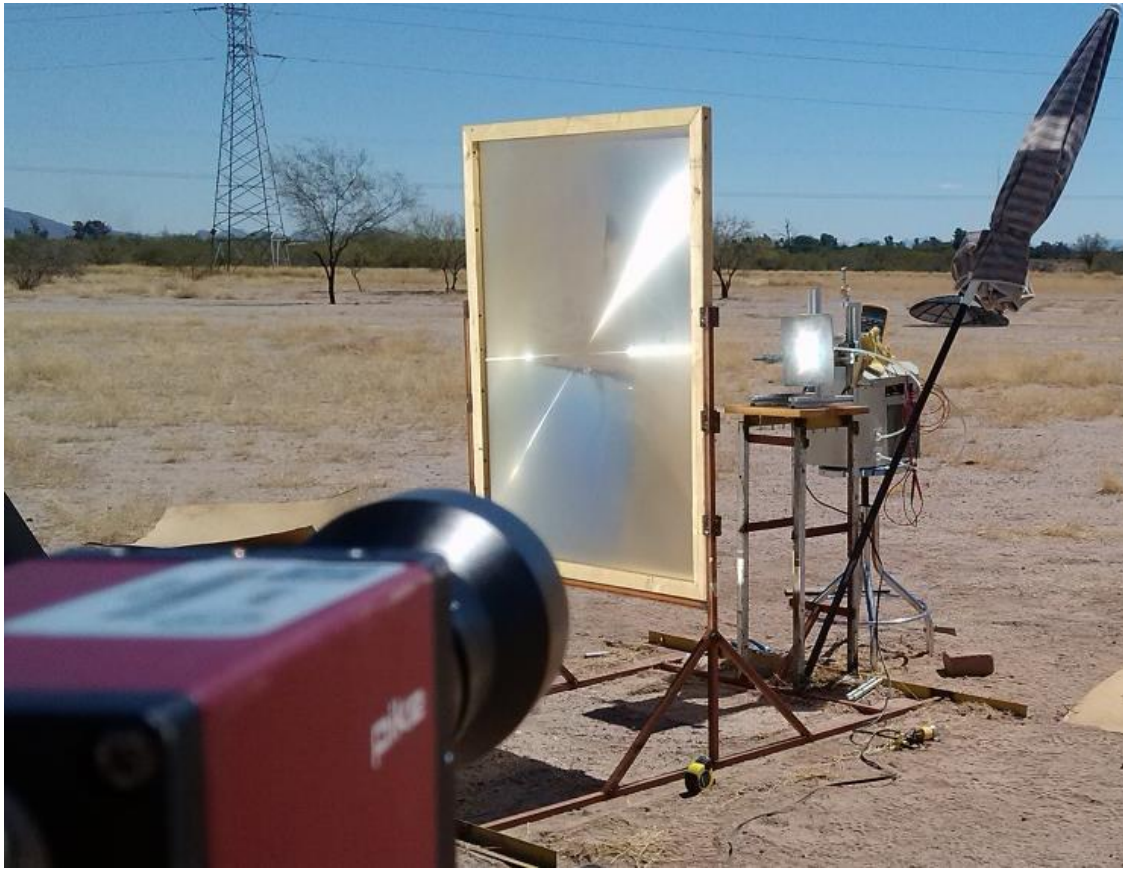
Figura 3.48 Horno solar en operación, generando una mancha de radiación concentrada sobre la placa de aluminio.
