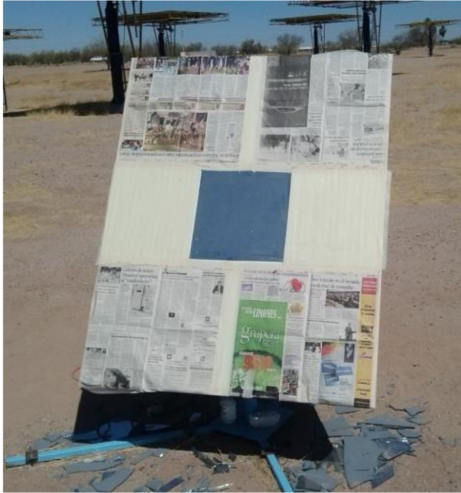
Figura 3.43 Superficie del heliostato parcialmente cubierta para generar una proyección de menor área.
