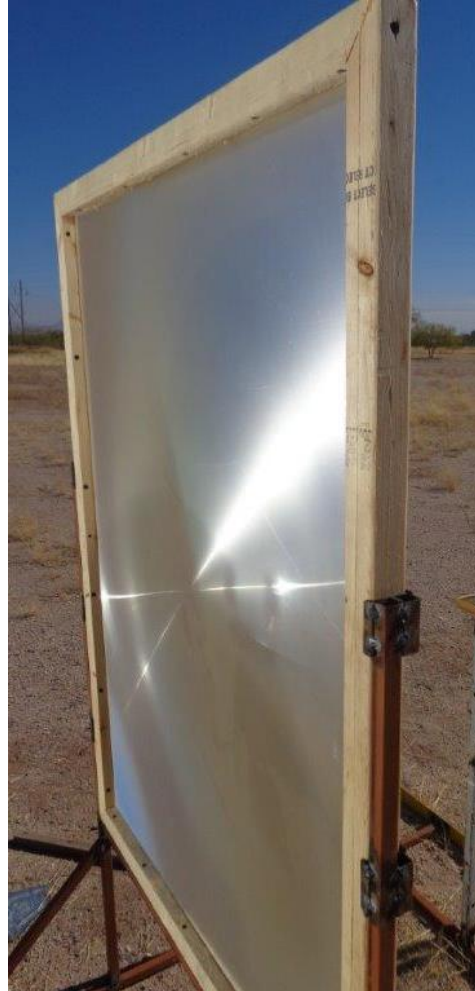
Figura 4.3 Lente fresnel utilizada como elemento concentrador primario en el horno solar.
