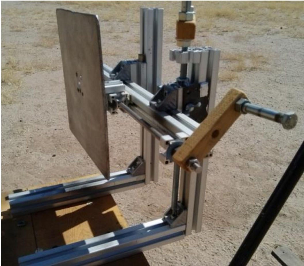
Figura 3.46 Placa plana utilizada como receptor, con capacidad de movimiento en dos ejes.
