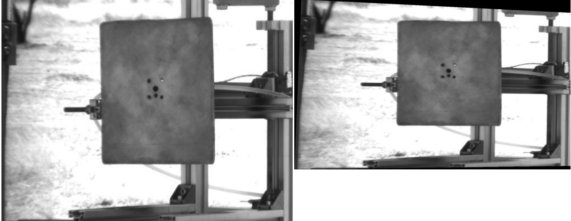
Figura 3.47 Imagen maestra original con objetos de dimensiones conocidas (izquierda). La misma imagen con corrección por perspectiva (derecha).
