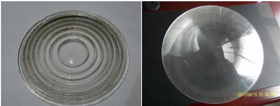
Figura 4.2 En la imagen de la izquierda y de la derecha se muestra una lente fresnel con un bajo número y un alto número de segmentos de curvatura, respectivamente.
