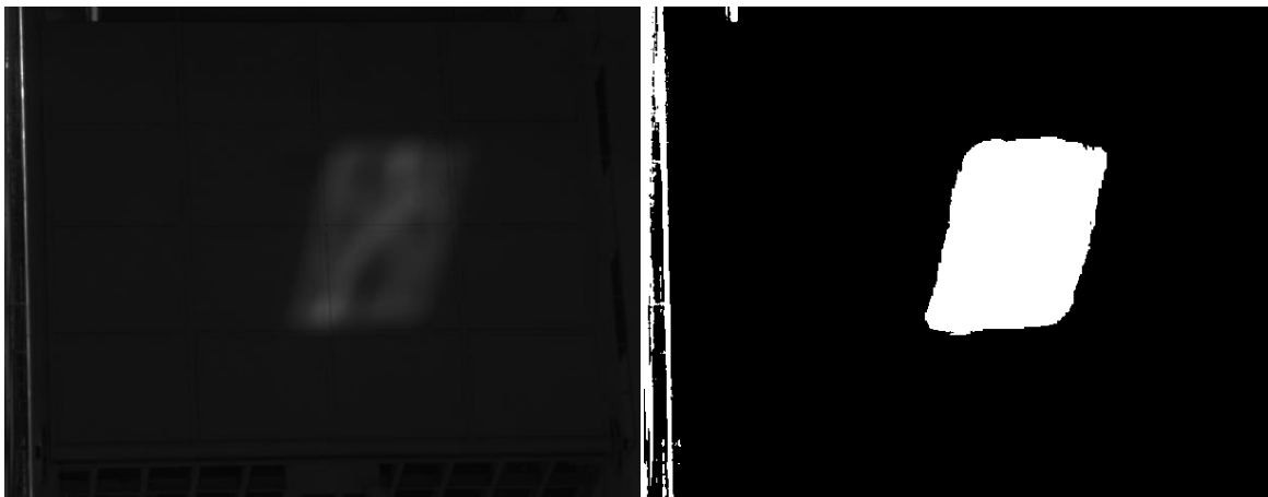
Figura 3.42 Imágenes de la proyección del helióstato sobre el blanco lambertiano en la torre central del campo (izquierda). Tratamiento de la misma imagen con función de umbral de color (derecha).
