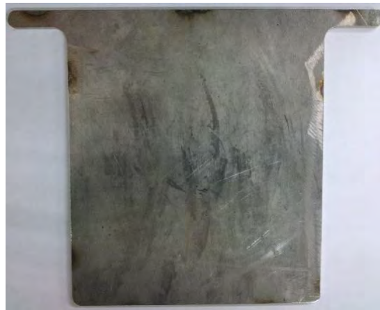
Figura 3.4 Diseño y cátodo de acero inoxidable
