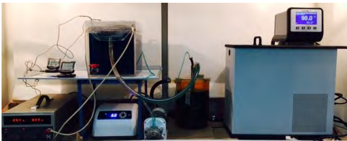
Figura 3.8 Equipos. 1) Fuente de poder, 2) Termómetros, 3) Celda electrolítica, 4) Bomba peristáltica y controlador 5) Vaso 6) Termocirculador
