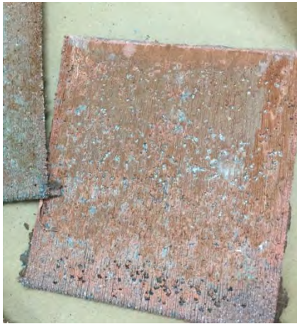
Figura 3.7 Aditivos y depósitos sin aditivos. Arriba: aditivos NaCl, tiourea y goma. Abajo: depósitos de pruebas preliminares sin aditivos
