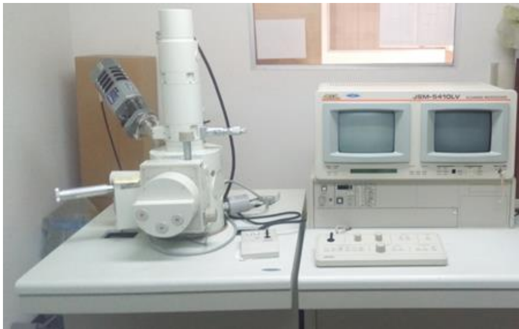
Figura 3.3.2 Equipo de microscopía electrónica de barrido del Departamento Investigación en Polímeros y Materiales de la Universidad de Sonora
