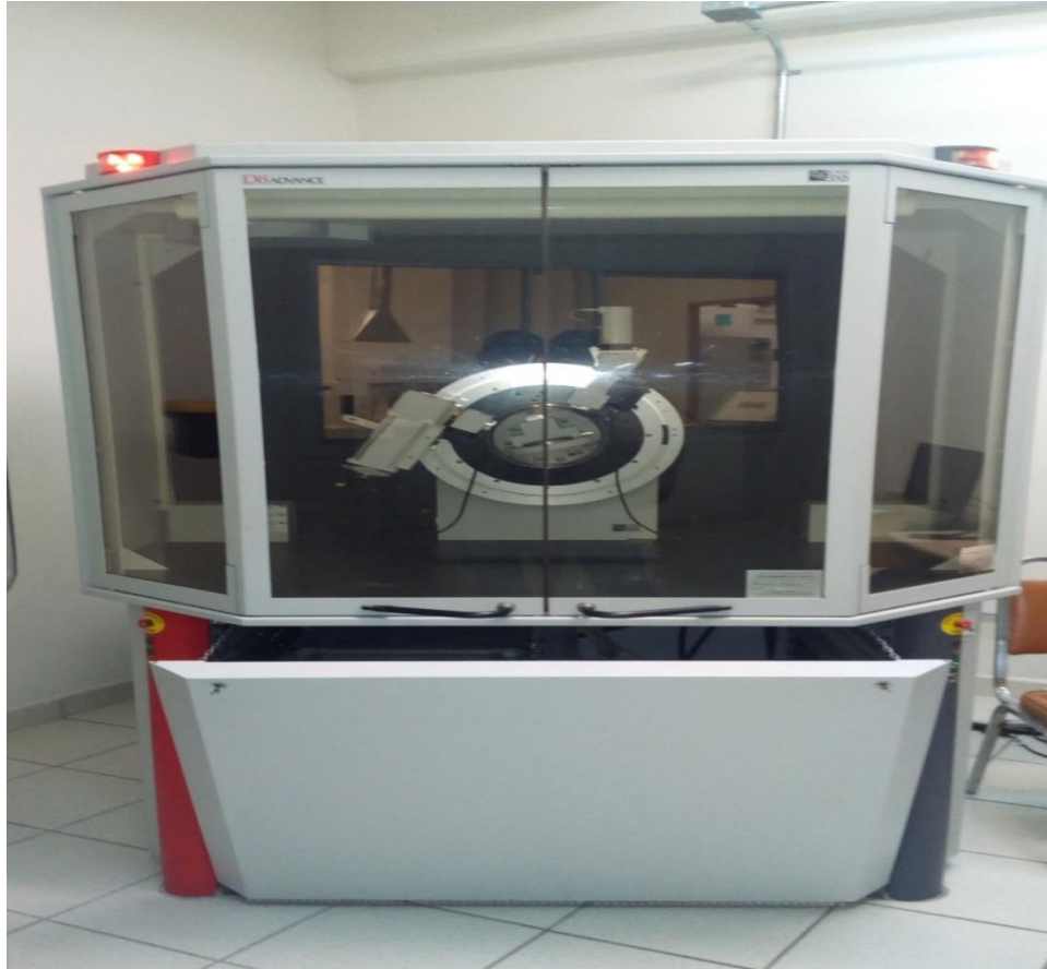
Figura 3.3.1 Equipo de difracción de rayos X marca BRUKER D8 advance del Departamento de Geología de la Universidad de Sonora
