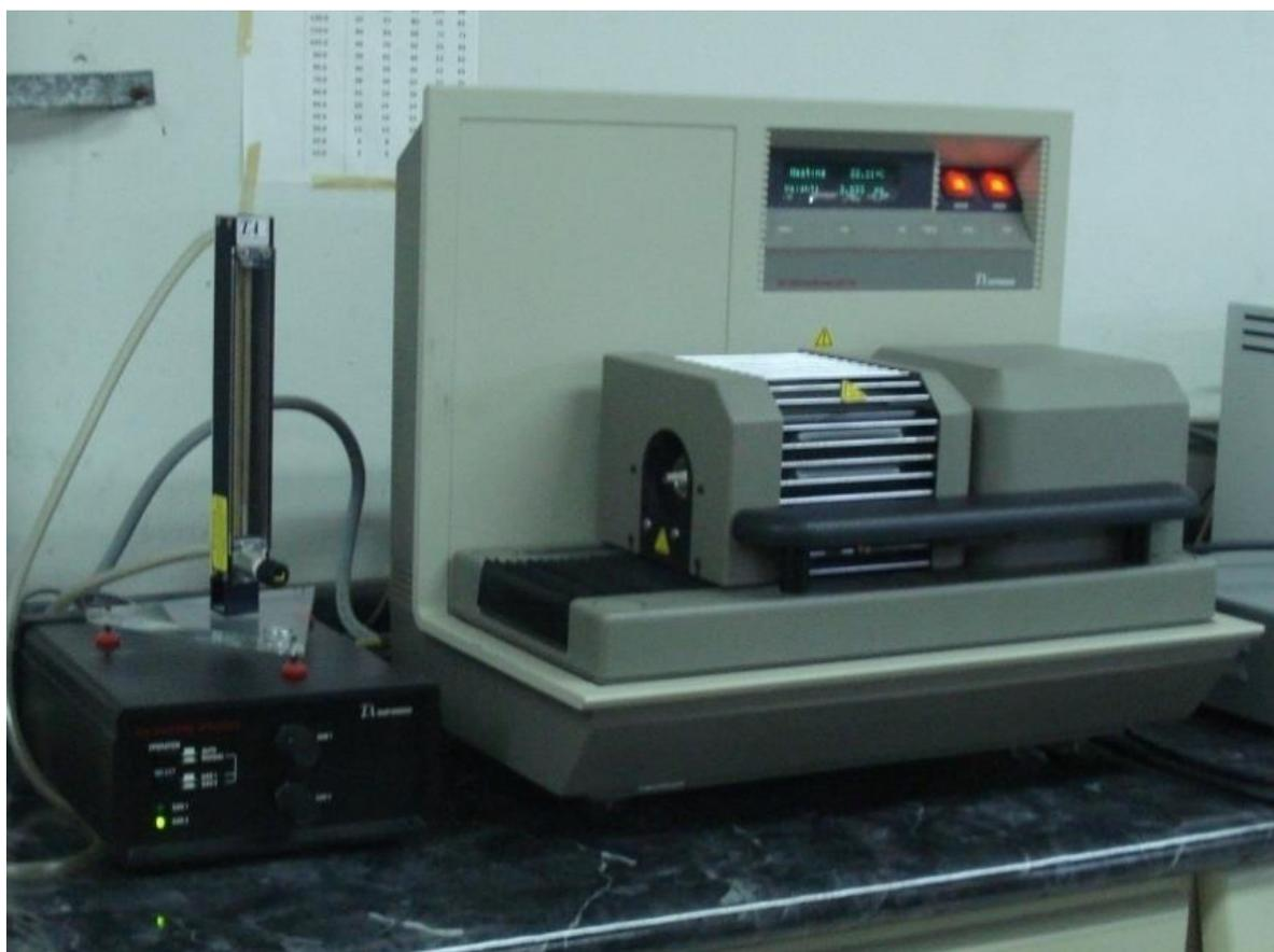
**Figura 8.** Analizador Simultaneo DSC-TGA.
