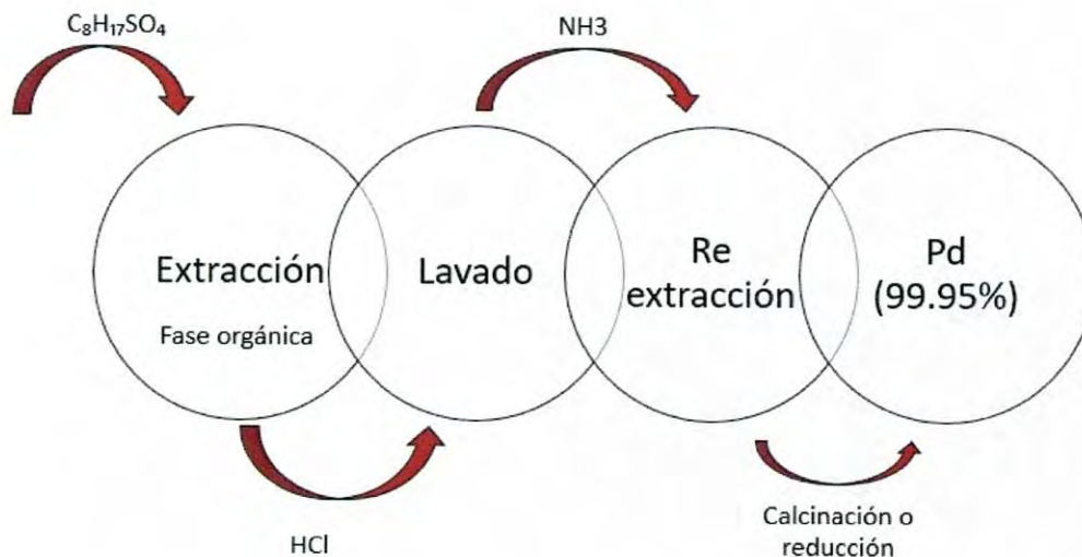
Figura 16. Diagrama de extracción por solventes de Pd en el proceso INCO.
