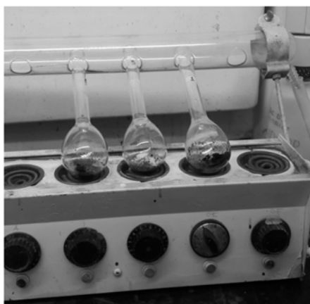
Figura 19. Muestras de EAST en proceso de digestión, en un digestor micro Kjeldahl, para la cuantificación de proteína total.
