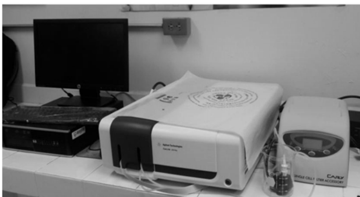
Figura 18. Espectrofotómetro UV-Vis Cary 60 (Agilent Technologies® CA, USA).
