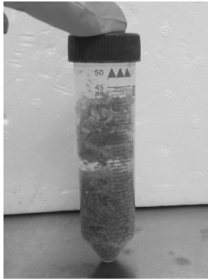
Figura 8. Salvado de trigo seco, con agua HPLC, en una relación 1:10 (p/v).
