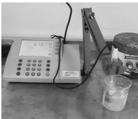
Figura 14. Lectura de pH y temperatura en el potenciómetro.
