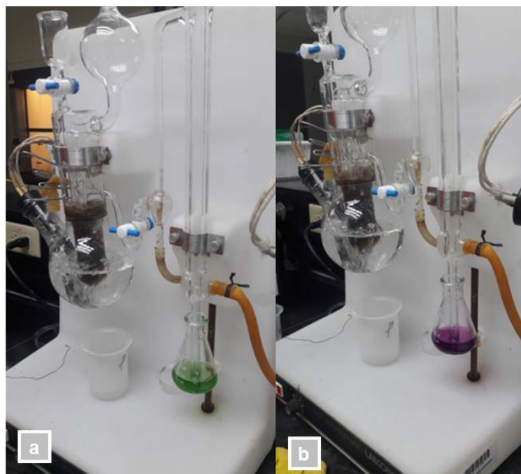
Figura 21. Destilador Labconco. a) Inicio de la destilación; b) Fin de la destilación.
