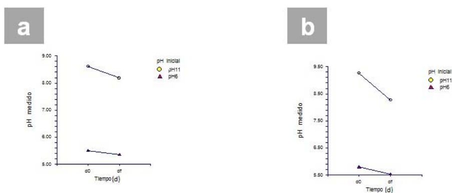
Figura 32. Comportamiento de los valores promedios de pH medido con respecto al tiempo y su pH inicial. a) EAST sin modificar; b) EAST desengrasado
