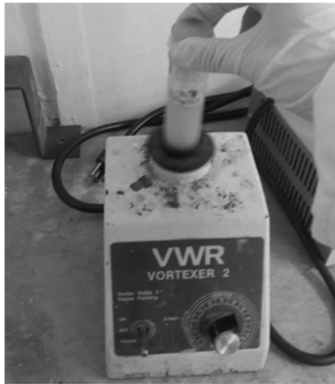
Figura 15. Homogenización de las soluciones de EAST con cristales precipitados, en un agitador Vortexer 2 VWR.
