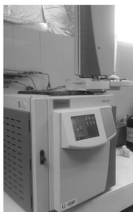
Figura 26. Cromatógrafo de gases CG Agilent modelo 6850 (Agilent Instruments, Santa Clara, CA, USA).
