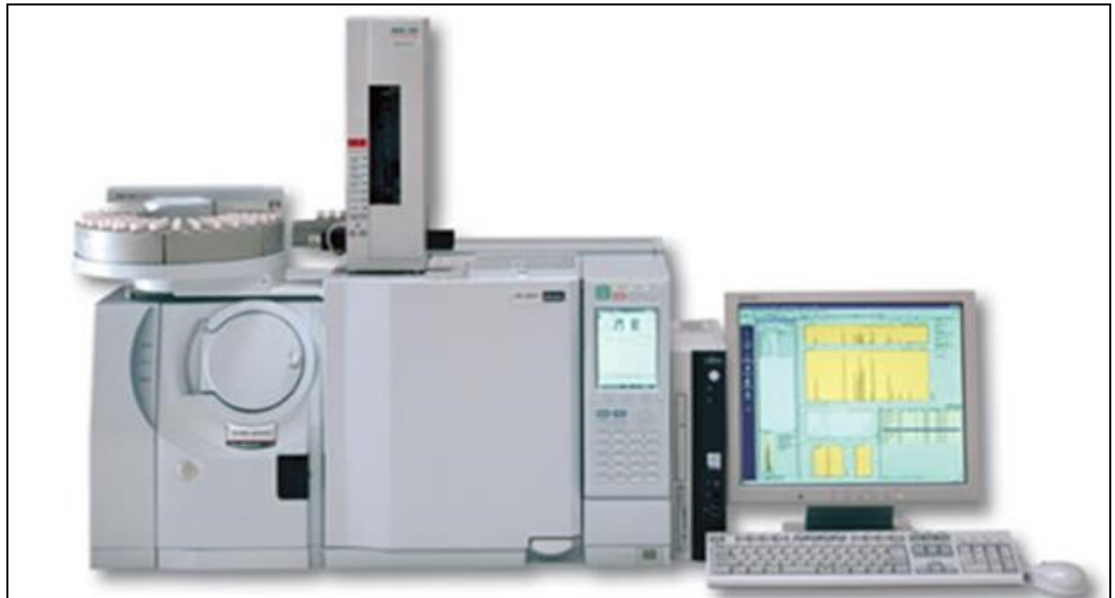
Figura 8. Cromatógrafo de gases con detector de ionización de flama (CG-FID) Agilent Technology, modelo 6890N network GC System, con autoinyector.
