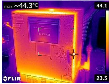
Figura 13 Hornos de sellado encendidos en tiempos de inactividad en la producción (Amphenol).
