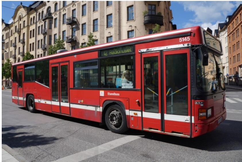
Imagen D14. Autobús estándar a bioetanol de la compañía SL en la ciudad de Estocolmo. Fuente: Elaboración propia
