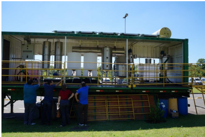
Imagen D8. Usina móvil de producción de biodiesel en la ciudad de Sorocaba, Brasil. Fuente: Elaboración propia
