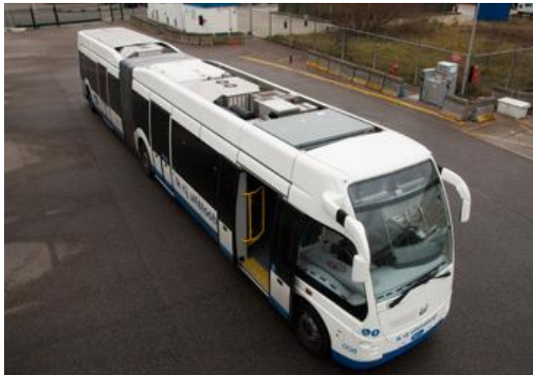
Imagen D12. Autobús de celdas de combustible de hidrógeno fabricado por la compañía holandesa APTS (arriba el esquema y abajo el modelo real). Fuente: GVB (2014b)
