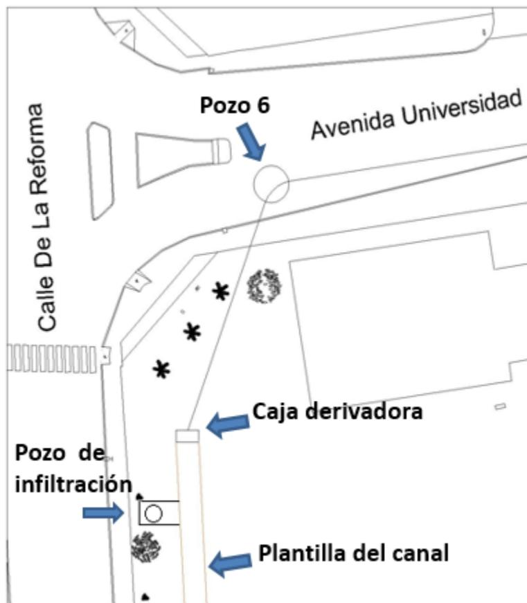
Fig. 30 Tramo pozo final del sistema pluvial y caja derivadora
