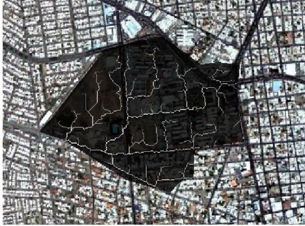
**Fig. 10 Simulación del flujo de drenaje pluvial sobre las vialidades de la Universidad de Sonora**
