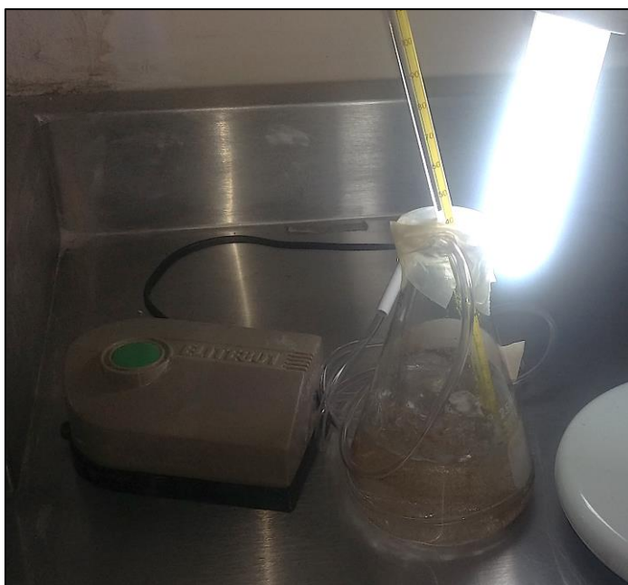
Figura 11. Matraz para eclosión de Artemia salina durante 24 h a 25 °C en agua salina bajo aireación y luz artificial.
