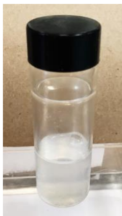
Figura 14. Suspensión biocompositos de quitosano/ácido pirrol-2-carboxílico obtenidas por el método de nanoprecipitación.
