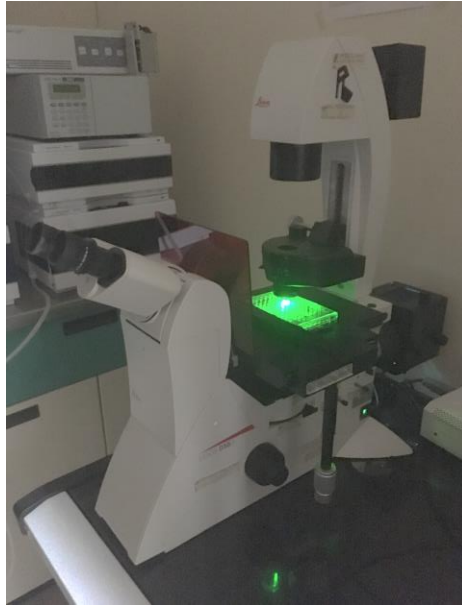
Figura 12. Microscopio invertido equipado con filtros de fluorescencia (Leica DMI8) y cámara enfriada DFC 450C (Leica).
