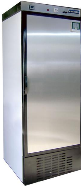
Figura 13. Cámara de crecimiento con monitoreo de humedad relativa y temperatura (Novatech, CA-550).
