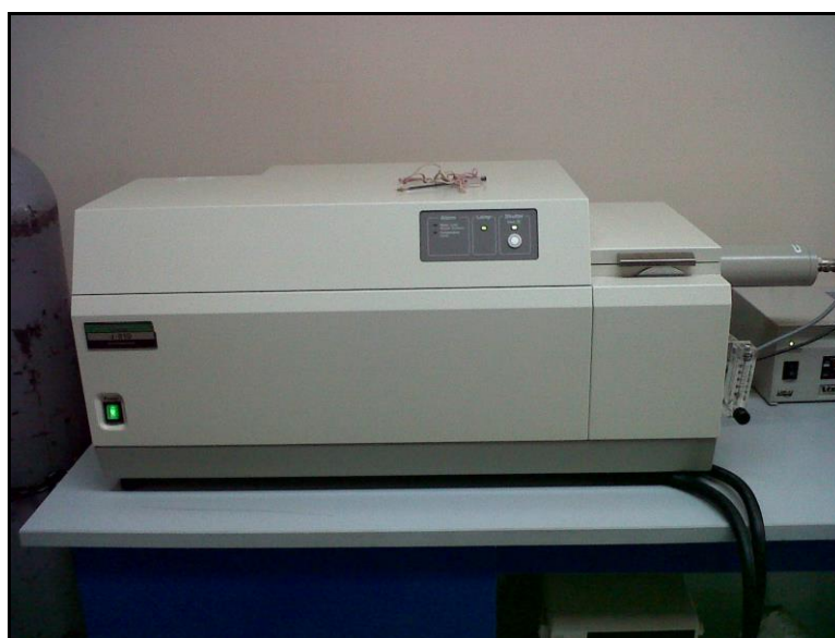
Figura 15.- Espectropolarímetro de la marca Jasco (modelo J-810).
