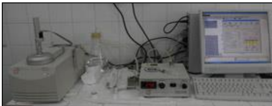
Figura 14.- Microcalorímetro de titulación isotérmica de la marca MicroCal (modelo VP-ITC).
