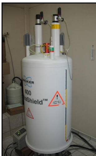
Figura 7.- Espectrómetro de resonancia magnética nuclear de la marca Bruker (modelo Avance 400).
