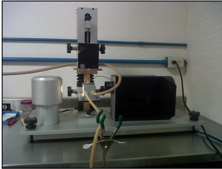
Figura 9.- Tensiómetro de gota de la marca I.T. Concept (modelo Tracker).
