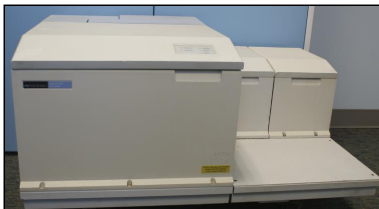
Figura 8.- Espectrómetro de infrarrojo de la marca Perkin-Elmer (modelo Spectrum GX).
