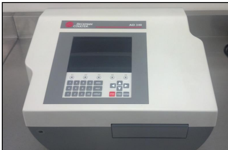
Figura 16.- Espectrofotómetro UV-Vis de la marca Beckman Coulter (modelo AD-340).
