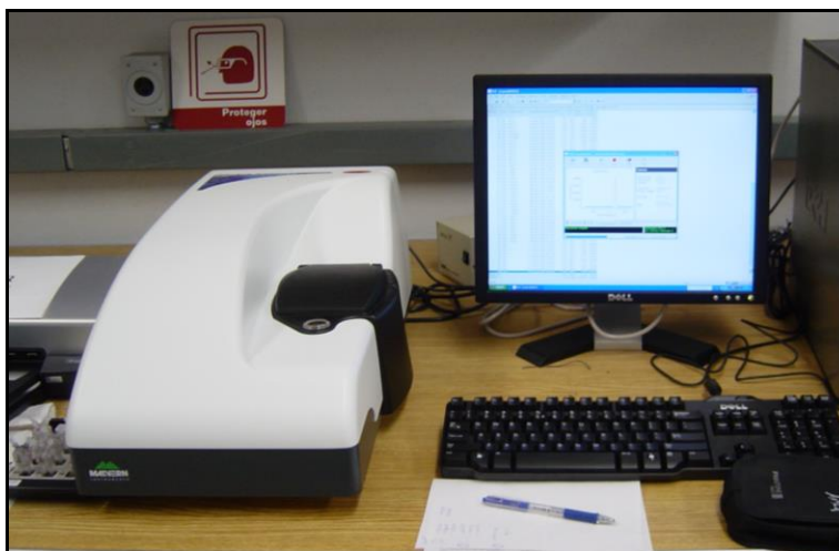
Figura 11.- Zetámetro de la marca Malvern Instrumens (modelo Nano ZS).
