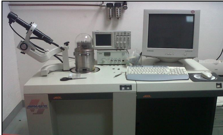
Figura 12.- Microscopio de fuerza atómica marca JEOL (modelo JSPM-4210).
