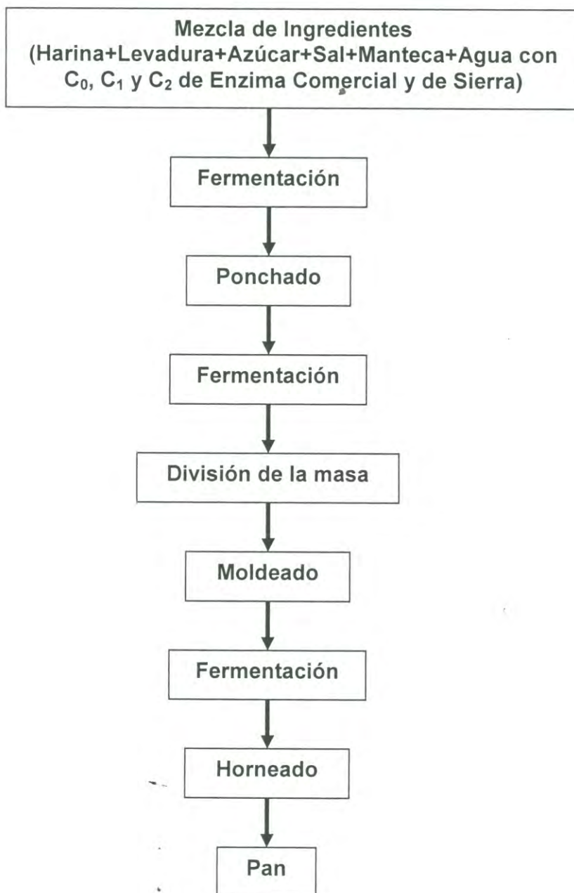
Figura 4. Proceso de elaboración del pan por el método de masa directa 10-10 B, AACC.
