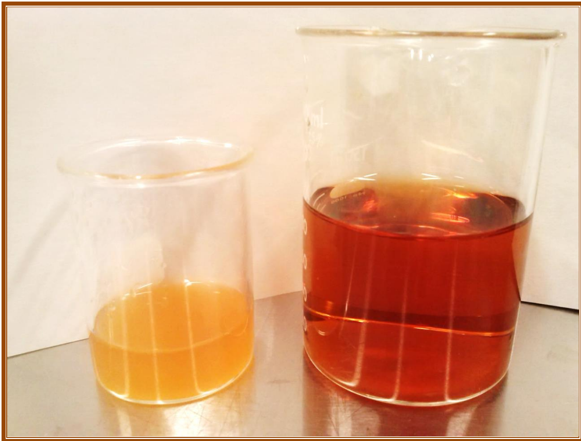
Figura 28. Comparación de permeado cuando la membrana está rota (izq.) y en buenas condiciones (der).
