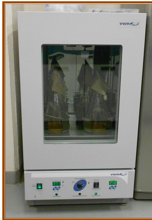
Figura 6. Incubadora VWR Orbital Shaker Incubator utilizada para las cinéticas de crecimiento a nivel matraz
