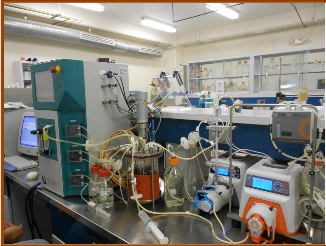
Figura 7. Sistema perfusivo formado por el controlador Applikon eZ-Control, el biorreactor, el sistema KrosFlo Research III con el módulo de microfiltración y la bomba peristáltica Cole-Parmer Masterflex L/X en el Laboratorio de Bioprocesos
