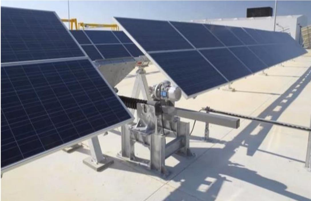
**Figura 2.7.** Modelo MS-1EH, el actuador lineal mueve varios arreglos de paneles dispuestos alrededor de un eje, situado de norte a sur (1 Axis Solar Tracker, 2012).
