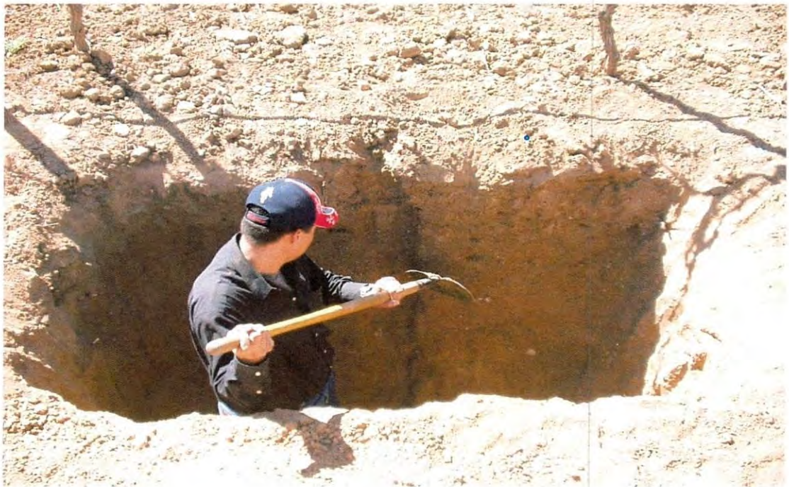
Fotografía 9. Toma de muestras del perfil del suelo en pozo agroecológico del campo experimental de la UES
