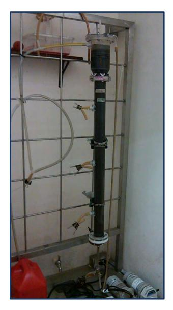
Figura 30. Reactor EGSB utilizado para las pruebas en continuo.
