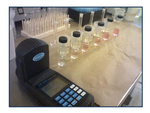
Figura 28. Determinación de nitratos y nitritos por colorimetría.
