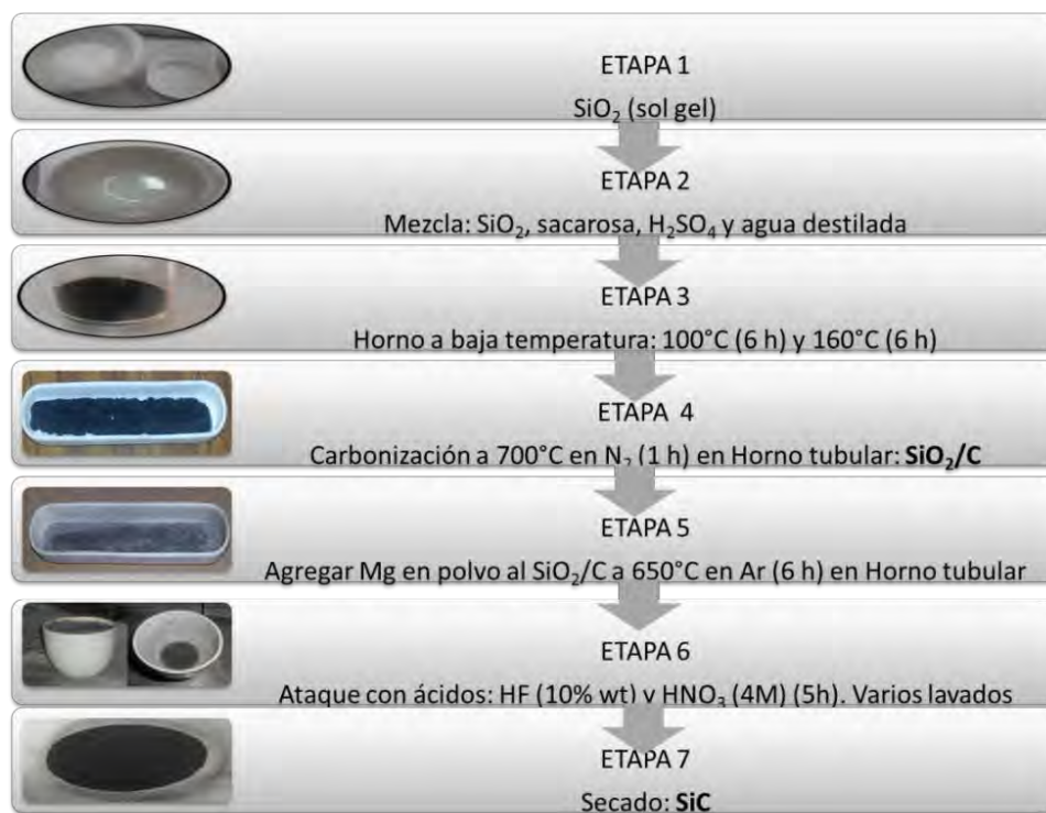
Figura 3.4. Etapas del procedimiento de síntesis de SiC por el método magnesiotérmico en horno tubular.
