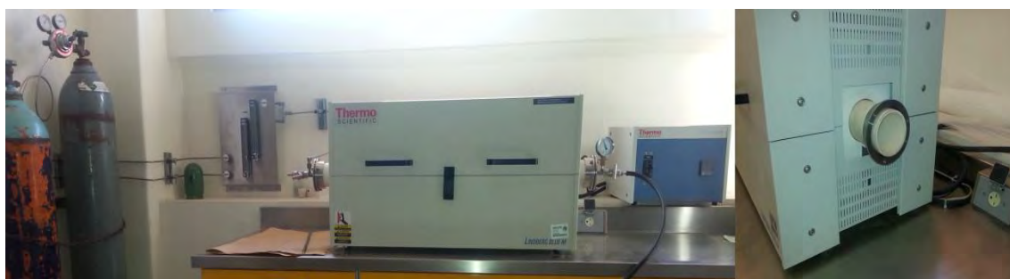
Figura 3.10. Horno tubular Thermo Scientific Lindberg Blue M, con tubo de alúmina en la UNISON.
