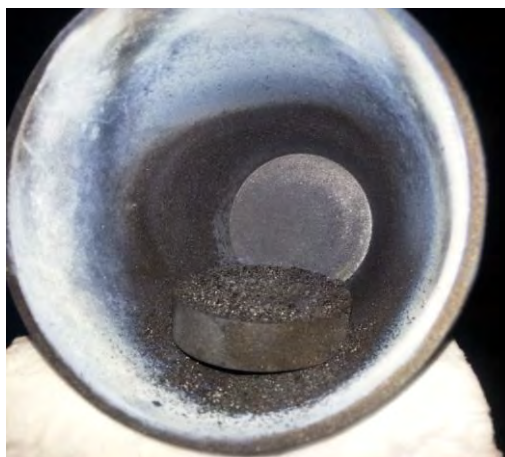
Figura 4.89. SiC obtenido con energía solar concentrada.
