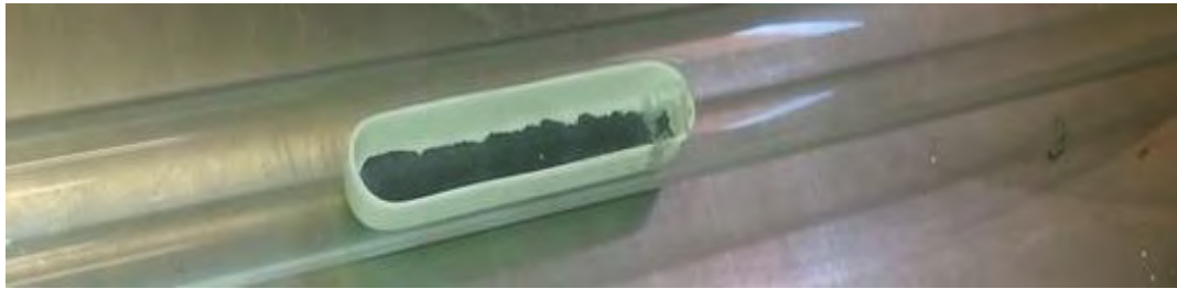
Figura 3.5. Montaje para la síntesis del compuesto \text{SiO}_2/\text{C} , en la etapa 4.
