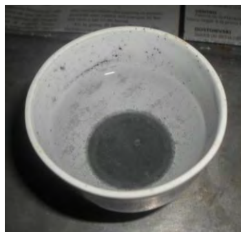
Figura 3.8. Etapa 7: lavado de la muestra para la obtención de \text{SiC} .
