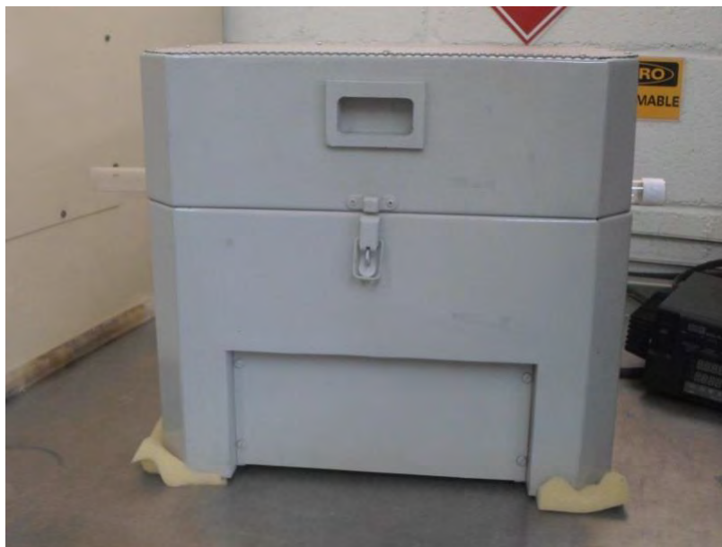
Figura 3.9. Horno tubular Carbolite, con tubo de cuarzo en CIMAV.
