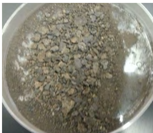
Figura 4.42. Composito obtenido con SiO 2 /C con SBA-15.
