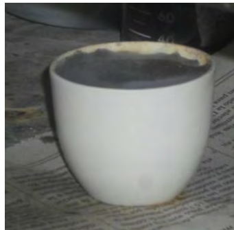
Figura 3.7. Etapa 6: ataque con \text{HF}/\text{HNO}_3 para la eliminación de impurezas.
