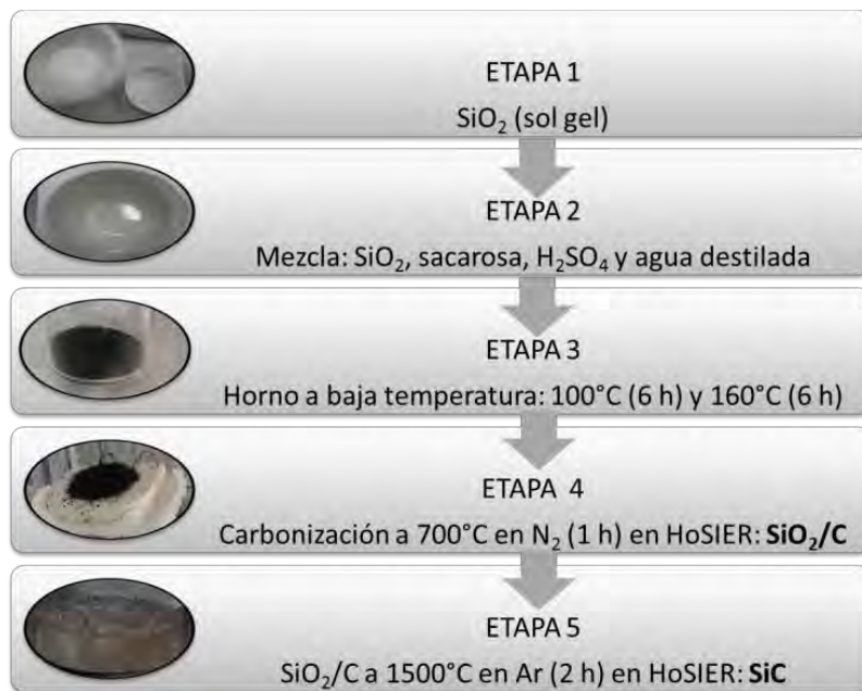
Figura 3.11. Etapas del procedimiento experimental de la síntesis de SiC en horno solar.
