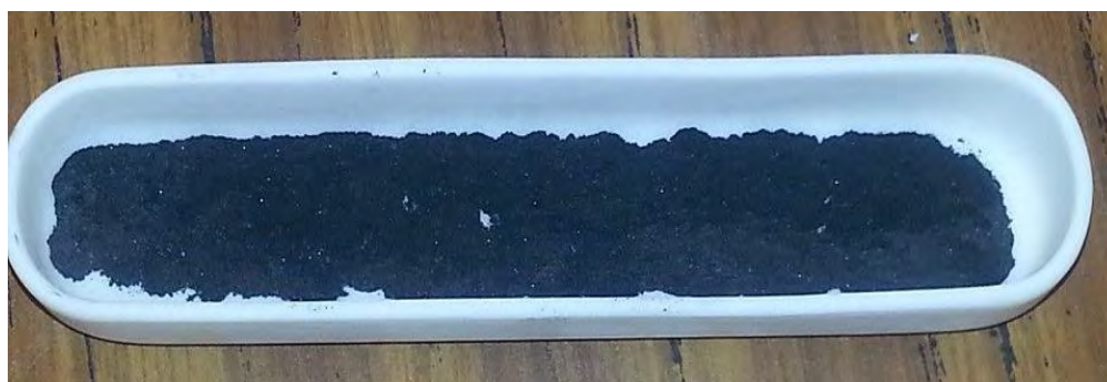
Figura 4.41. Composito SiO 2 /C obtenido con sílice sintetizada.
