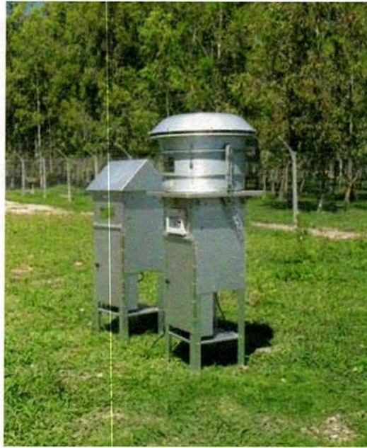
Figura 2.1. Equipos manuales de muestreo de partículas en suspensión, totales y menores a diez micrones de diámetro aerodinámico, por filtración de alto volumen de aire, disponibles en el mercado.
