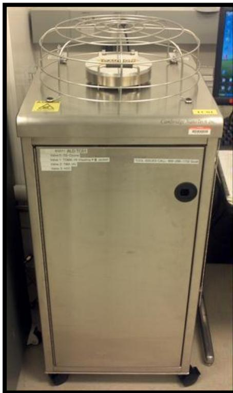
*Figura 18:* Equipo para depósito por capas atómicas.
