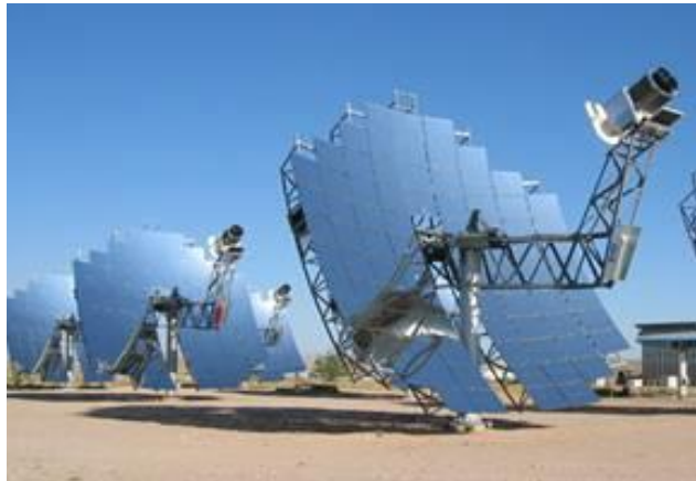
Figura 2.26. Concentradores de plato parabólico de la Planta Sistemas de Energía Stirling (SES), en California, E.U.A.
