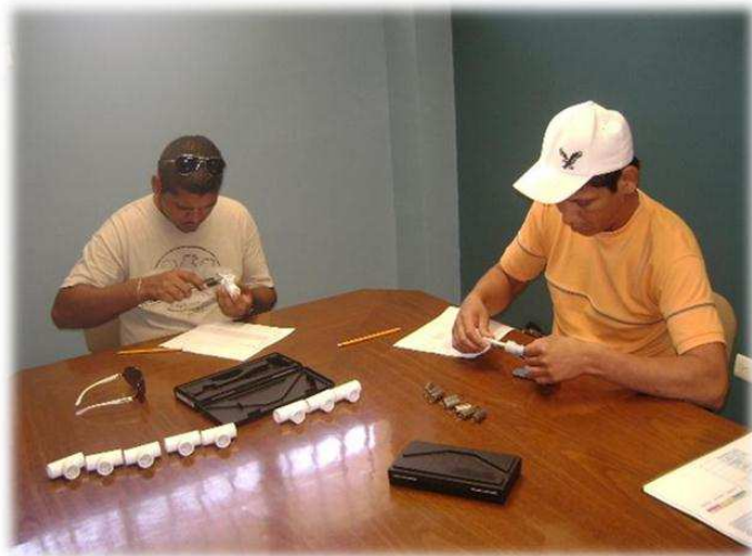
Figura 4.11. Personal técnico de TMI en ejercicios de práctica de ensayos de diámetro interior y diámetro exterior.
