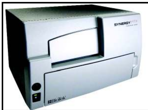
Figura10. Incubadora SYNERGYHTX para la evaluación de la Concentración Mínima Inhibitoria de las nanopartículas de plata y del extracto de Rumex .
